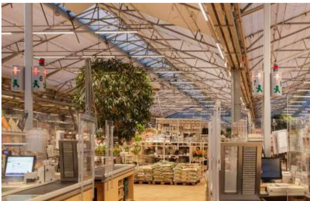
Gli inserti led LED con un flusso luminoso di 8100 lm all'altezza delle travi principali generano un'intensità luminosa di circa 800 lx.
