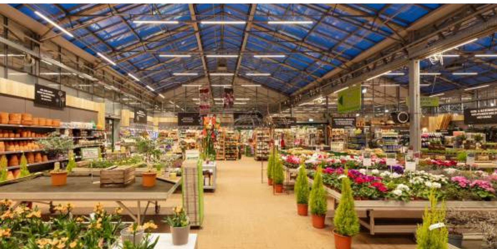
Le aree espositive dedicate a piante, mobili da giardino, attrezzi e accessori sono valorizzate da inserti a LED con un flusso luminoso di 14050 lm, qui si ottengono intensità luminose comprese tra 1000 e 1500 lx.
